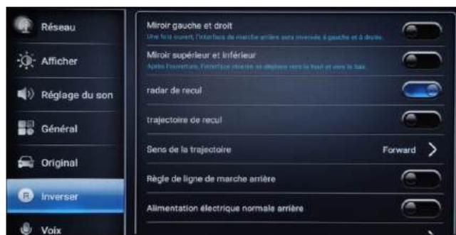
Inverser : Permet de modifier les paramètres de caméra de recul, afficher ou désactiver les lignes, sens de la trajectoire, inversion, réglage du son etc...
